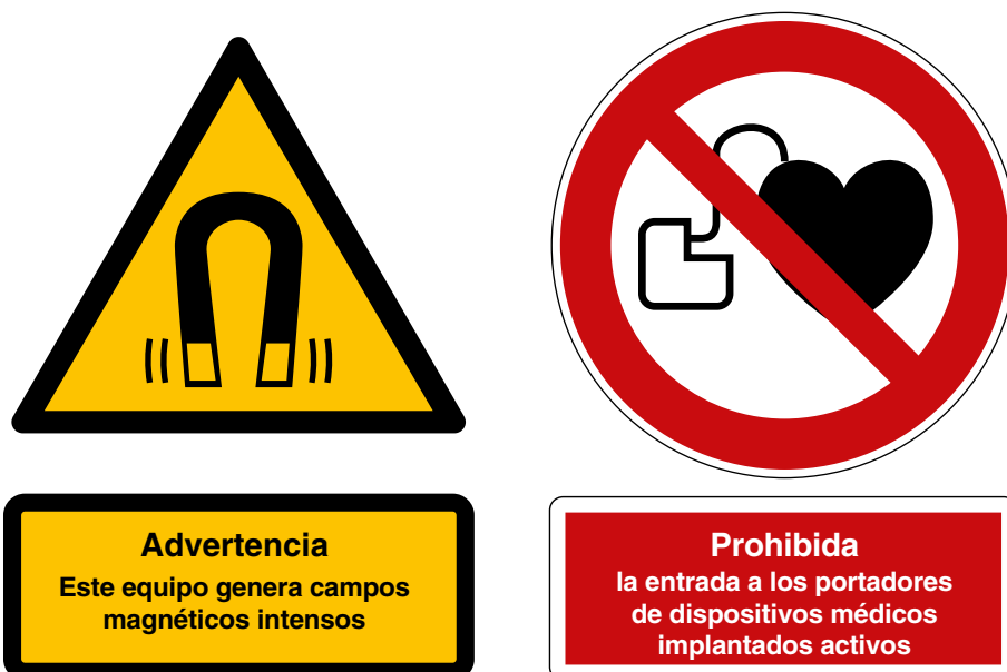
Figura 4.12. Ejemplos de señales de advertencia de campos magnéticos intensos y una ilustración del símbolo de prohibición para portadores de DMIA
