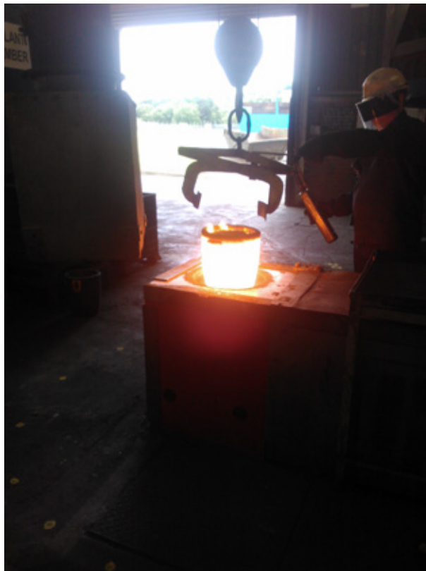
Figura 8.5. Las labores que implican un acceso próximo al horno se llevaban a cabo con el horno apagado
