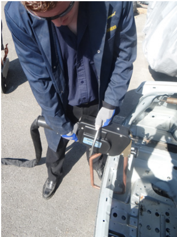
Figura 6.1. Equipo manual de soldadura por puntos utilizado para montar un nuevo panel
