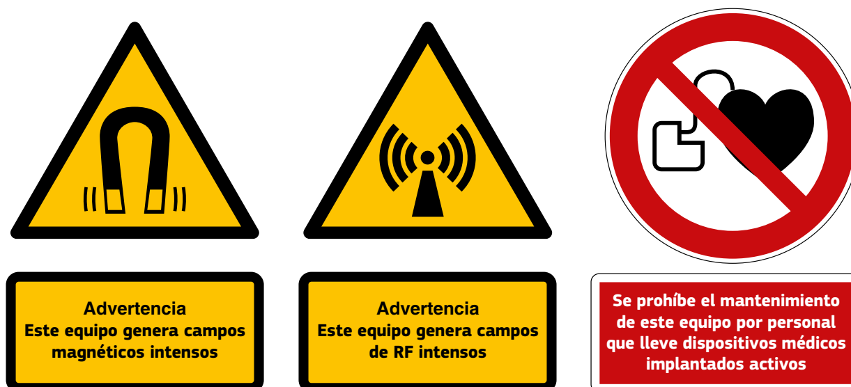
Figura 9.5. Ejemplos de señales de advertencia de campos magnéticos y de RF intensos e ilustración del símbolo de prohibición para las personas que lleven DMIA
