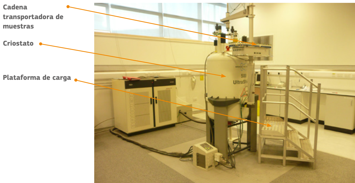
Figura 2.1. Unidad RMN, completa con cadena transportadora de muestras y plataforma de carga
