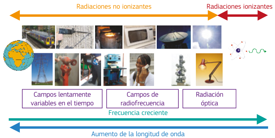
Figura 3.1. Representación esquemática del espectro electromagnético, con la indicación de ciertas fuentes típicas
