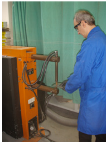
Figura 9.10. Ilustraciones de buenas y malas prácticas al disponer el puesto de trabajo para una soldadora de puntos y considerar la posición del operario
