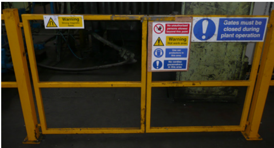
Figura 9.1. Ejemplo de un protector móvil simple empleado para restringir el acceso a un campo magnético intenso. En este caso, el protector no está dotado de dispositivo de bloqueo recíproco, aunque se complementa con señales de advertencia y medidas organizativas
